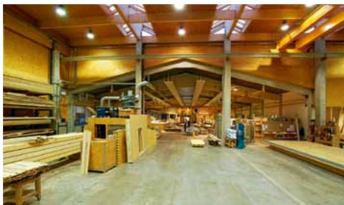
In den Loferer Werkshallen werden die Elemente vorgefertigt – dieselben Mitarbeiter sind dann auf der Baustelle für die Montage verantwortlich
